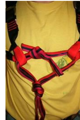
4) Protisměrný uzel krok 1 5) Protisměrný uzel krok 2
