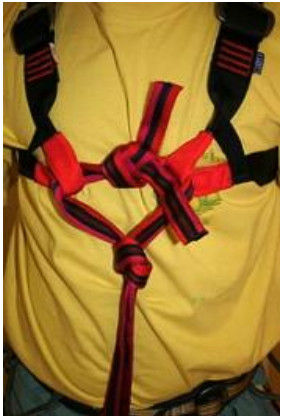
6) Protisměrný uzel krok 3 7) Protisměrný uzel krok 4
